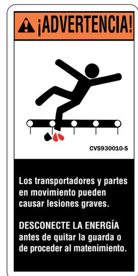
Para ser colocada en las entradas de alimentación y descargas, artesas cubiertas y puertas de inspección de los transportadores helicoidales para advertir contra la exposición a partes en movimiento durante la operación.
