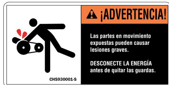
Para colocarse en las guardas para advertir que la operación de la maquinaria sin las guardas instaladas en su lugar es peligrosa al quedar expuestas cadenas, bandas, engranes, ejes, poleas, coples, etc.
